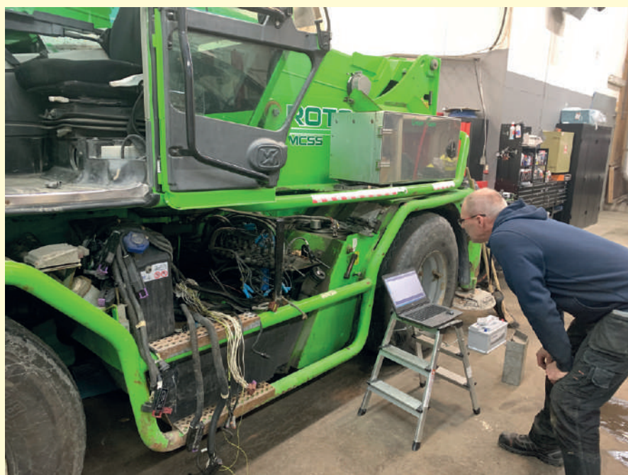
En gigantisk teleskoplastare med ett smärre elfel efter en kabelbrand väntar på åtgärd.
