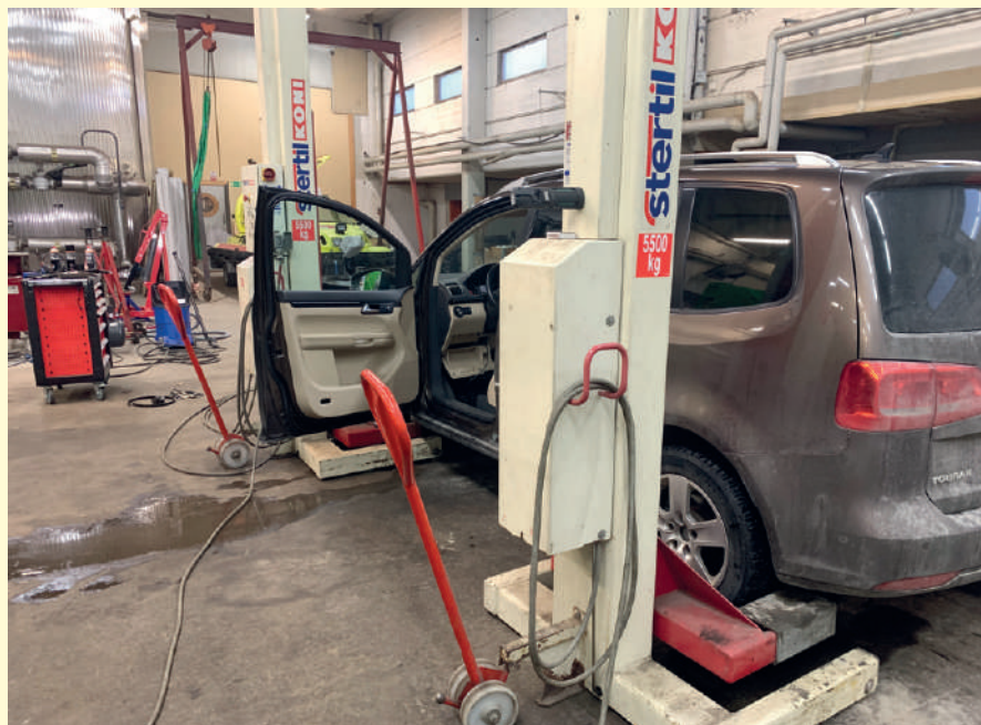
Fyra separat lyftar som tillsammans klarar fordon med en vikt på upp till 22 ton.
