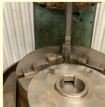
Med en av de lite mer udda maskinerna i verkstaden kan Stefan ta upp riktigt grova kilspår.
