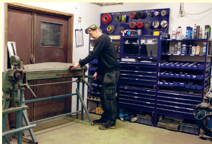
Rikard tillverkar ofta plåtdelar för att ersätta rostiga partier som skärs bort.
