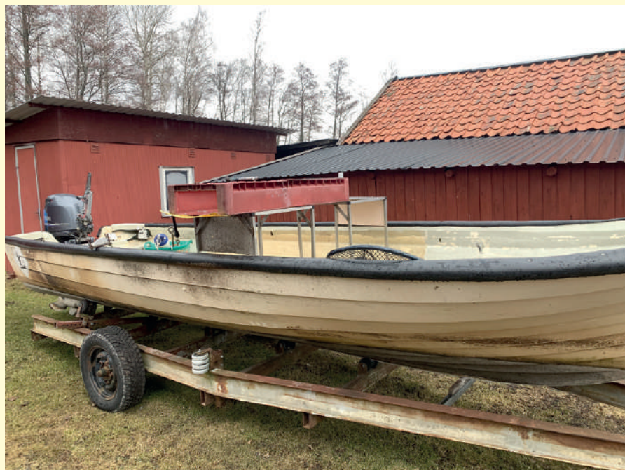
På båtarna finns rensbord monterade så att oönskad fisk snabbt kan släppas tillbaka i vattnet.
